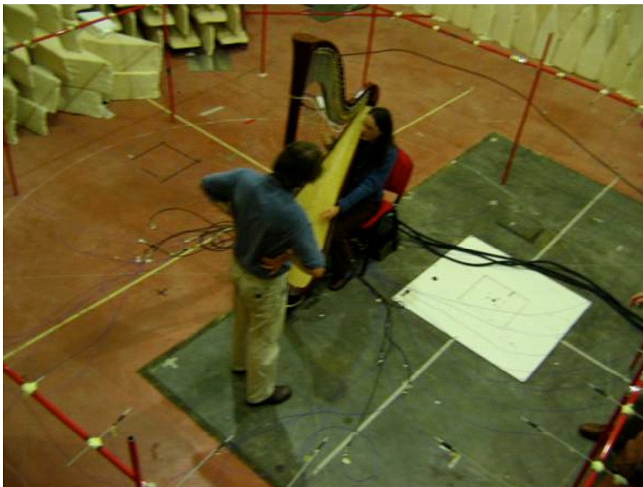
Figura 17: Fotografia do aparato experimental na medida temporal da direcionalidade.
