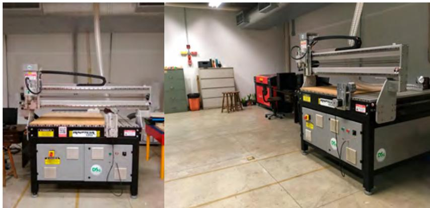
Figuras 1a (detalhe), 1b (visão geral). Fresadora *CNC Router* modelo Raptor 1313. Laboratório de Modelagem e Fabricação Digitais (ModelaFab), Espaço das Artes (EdA), Universidade de São Paulo (USP), São Paulo. Fonte: Equipe ModelaFab
