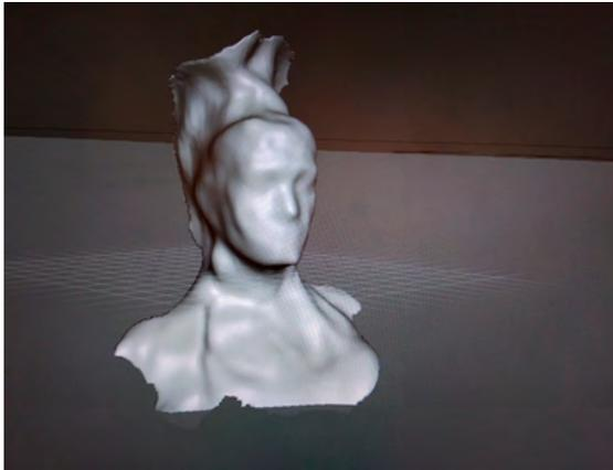
Figura 11. Resultado tridimensional do processamento de imagens capturadas no aplicativo *SCANN 3D*. O objeto foi posteriormente editado no programa *Meshmixer* da *Autodesk*. Laboratório de Modelagem e Fabricação Digitais (ModelaFab), Espaço das Artes (EdA), Universidade de São Paulo (USP), São Paulo. Fonte: Ministrantes do *workshop*.
